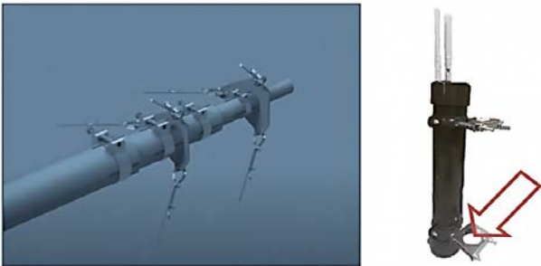
Рис. 3. Кріплення мачи бездротових ретрансляторів
