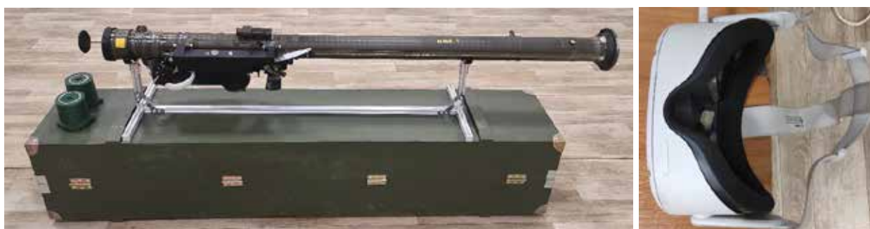
Рис 1. Тренажер ПЗРК “Stinger” з VR-контролером та комплектом віртуальної реальності “Oculus Quest 2”
