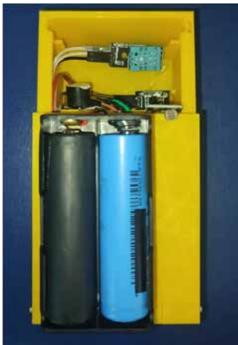
Рис. 1. Загальний вигляд метеорологічної станції без захисної сітки (використані: платформа ESP32, датчик температури та вологості DHT11, датчик температури DS18B20, фоторезистор, датчик атмосферного тиску GY-68 BMP180)
