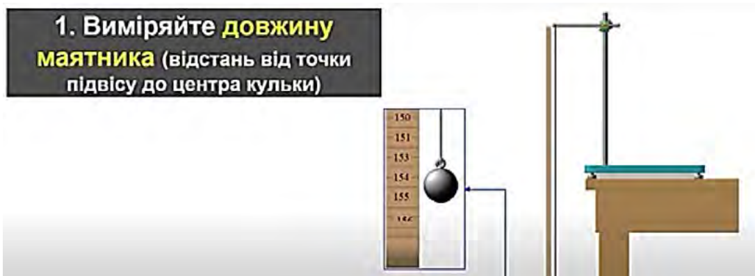
Рис. 1. Приклад демонстраційного експерименту дослідження закону збереження енергії за допомогою маятника
